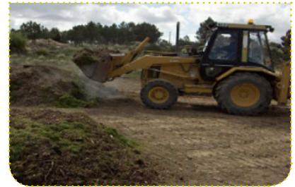
Nas pilhas revolvidas, a mistura de resíduos é colocada numa pilha comprida e é revolvida regularmente por acção externa, geralmente por meios mecânicos (Figura 12), ou então por meios manuais quando a pilha é de pequenas dimensões.
